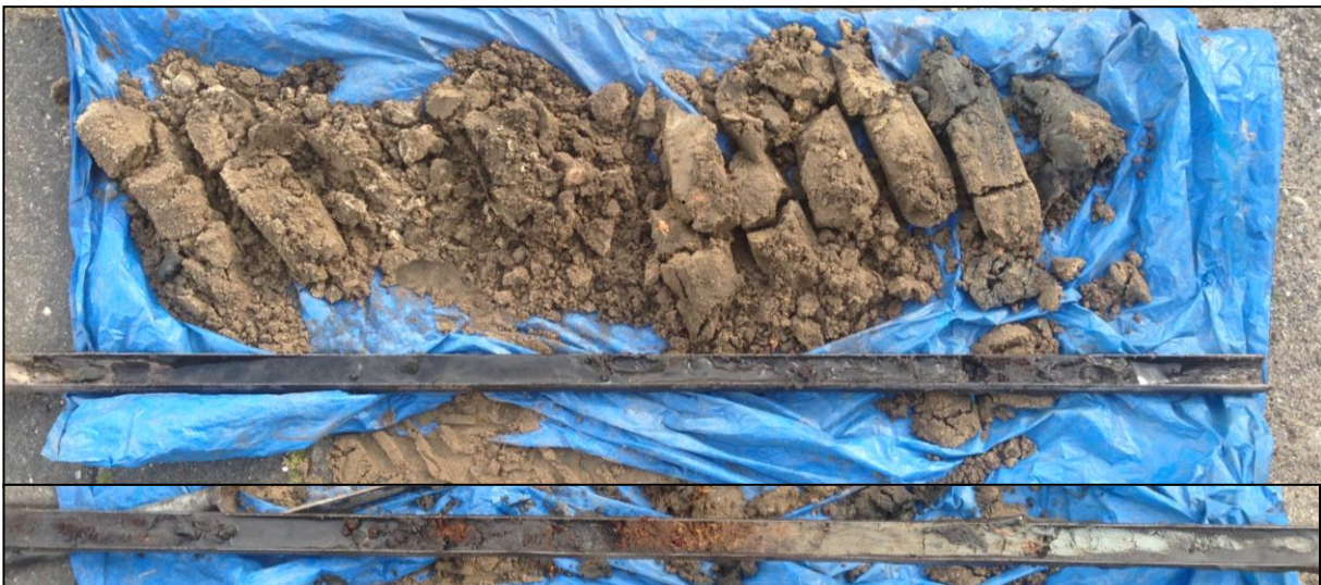
Boring 16: 0-300 cm. Rij boorkernen 0-100 cm -Mv, eerste guts 100-200 cm -Mv, tweede guts 200-300 cm -Mv.
